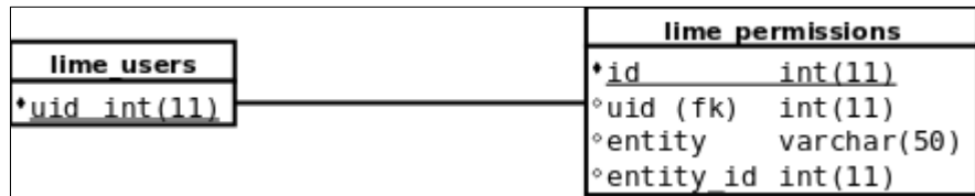
Figura 11. Relações entre as entidades lime_users e lime_permissions . (Há atributos de cada uma dessas entidades que não são exibidos na figura.) Criada com o software Dia Diagram Editor 0.97.3.
