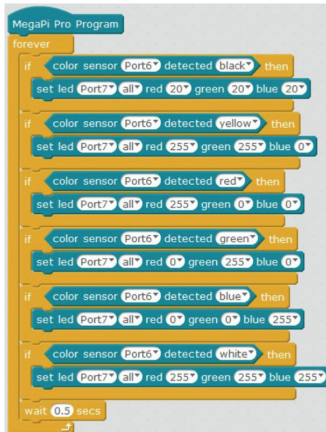
Figura 6. Exemplo de uso do sensor “Me Color v1.0” do mBot. Programação feita com o uso do Scratch (módulo do fabricante do mBot).
