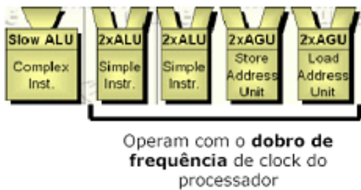
Figura 1. Esquema de funcionamento da ALU. Duas ALUs processam instruções mais simples, duas AGUs se encarregam de ler e gravar dados e uma terceira ULA é encarregada de decodificar/processar as instruções mais complexas
