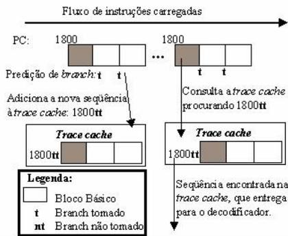
Figure 1: Visão geral do comportamento de uma *trace cache*
