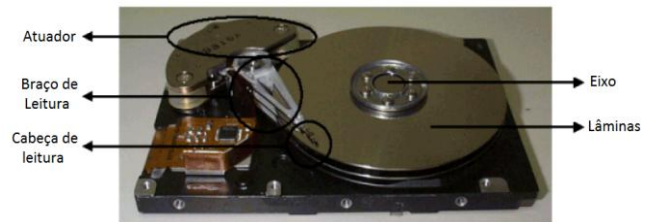
Figura 3. Estrutura física de um disco rígido.
