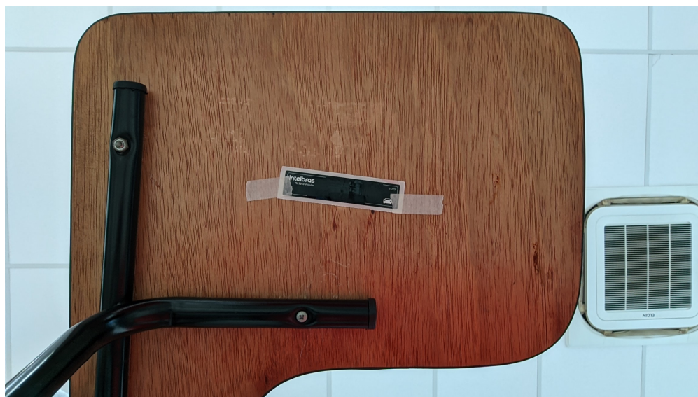
Figura 6: Tag posicionada abaixo do tampo da carteira para os testes de leitura da antena.
