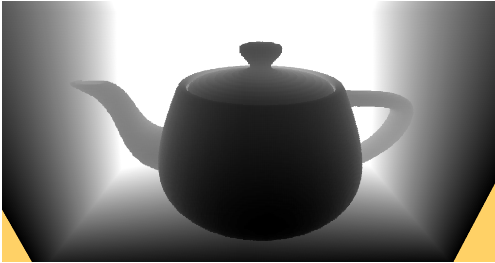
Figura 2: Visualização de debug de ray tracing usando grade uniforme. O nível de branco representa quantidade de iterações.
